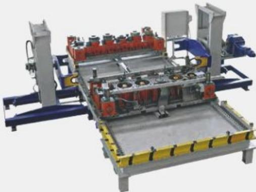
Das manuelle Handhaben der Werkzeuge außerhalb der Presse, unter Verwendung eines Kranes oder Gabelstaplers, verbraucht je nach Größe und Ausführung des Werkzeuges bei einem Personaleinsatz von mindestens zwei Facharbeitern üblicherweise 30 bis 90 Minuten.
